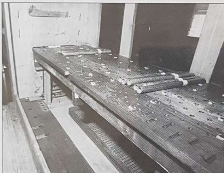
Il somiere restaurato durante il rimontaggio all'interno della cassa armonica.
