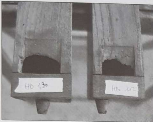
Le canne n.2 e 4 dell'Ottava attaccate dai topi prima del restauro.
